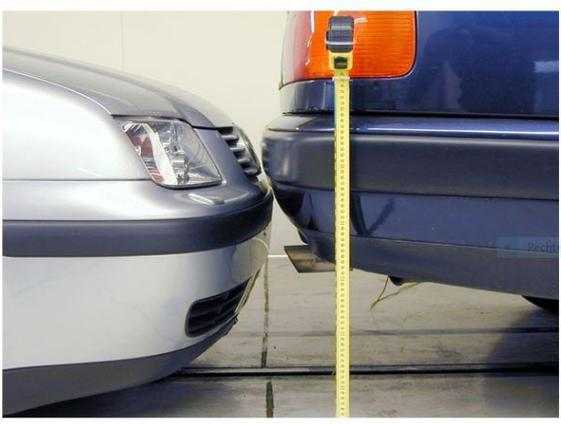
Ein VW Bora fährt ungebremst, mit 100 %-iger Überdeckung einem Audi 100 (ungebremst, kein Gang eingelegt) auf.
