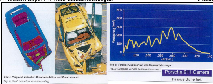
Bild 4: Vergleich zwischen Crashsimulation und Crashversuch Bild 5: Verzögerungsverlauf des Gesamtfahrzeugs Quelle: Bericht aus-ATZ-MTZ-Sonderheft (1997) 12-Passive Sicherheit des neuen Porsche 911 Carrera - Bericht von Horst Petri, Heinz Eberhardt und Herbert Klamser - dort Bild 4 + Bild 5.
